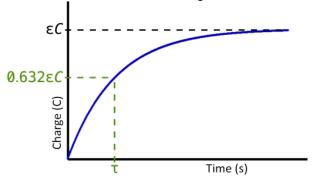
$$i(t) = i_{\text{max}}e^{-\frac{t}{\tau}} \Rightarrow i(\tau) = i_{\text{max}}e^{-\frac{\tau}{\tau}} = i_{\text{max}}e^{-1} \Rightarrow i(\tau) = 0.368i_{\text{max}}$$
